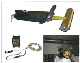
IH式被膜剥離
